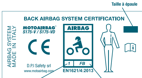
Levels 1 = Level 1 < 4,5 kN 2 = Level 2 < 2,5 kN Zone de protection FB arrière complet; CB = dos central DC = poitrine divisée + Type A (petit) or Type B (plus grand) fig 2.1
